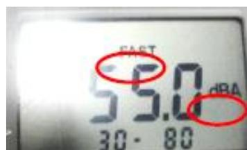
**2° Aferição:** Após a programação do equipamento, é realizado a aferição, atendendo às especificações da Norma ANSI S1.40-1984 ou IEC 942-1988. O aferidor é da mesma marca do medidor.
